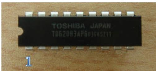
部品表面に「TD62083APG」と記載されています。ICの切欠きの部分が基板のマーキングと合う様実装してください。
