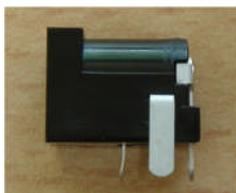
ACアダプタの差込口が基板の外側を向くように取り付けます。
